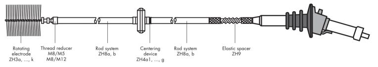
6 POROSCOPE® HV5, HV20, HV40
